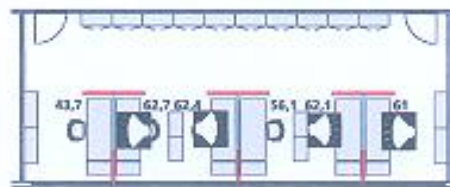
Raum mit Hochleistungsschallschirmen 4 Sprecher mit je 62 dB
