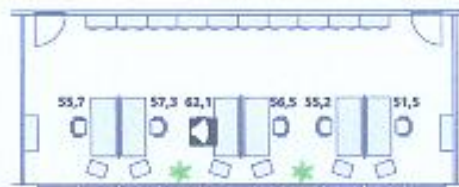
Raum mit zusätzlichen Akustikstellwänden 1,8 x 2m 1 Sprecher mit 62 dB
